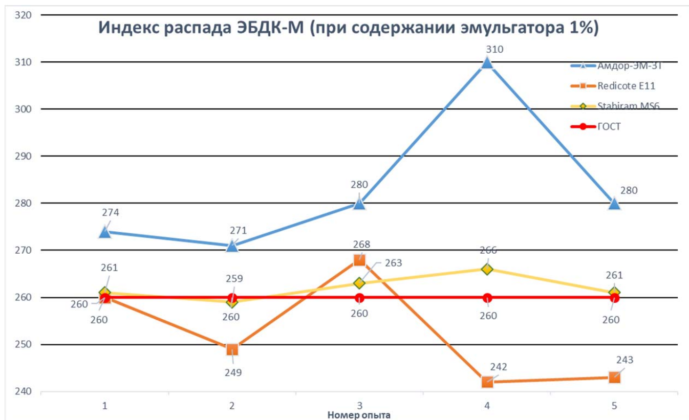
Рис.4 Индекс распада ЭБДК-М при использовании песка кварцевого
